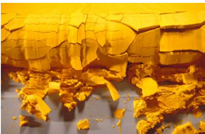
Bis das im Bergbau gewonnene Uranoxid als Kernbrennstoff in einem Reaktor eingesetzt werden kann, braucht es **mehrere Verarbeitungsschritte**. Vor der Anreicherung wird das **Uranerz zu Pulver gemahlen** und durchläuft anschliessend einen **mehrstufigen chemischen Prozess**. Dabei entsteht das Urankonzentrat  $U_3O_8$ , auch „**Yellow Cake**“ genannt.
