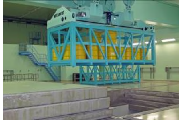
Lagerhalle für mittel aktive Abfälle
