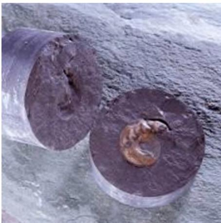
*En profondeur et sans évolution depuis des millions d'années: l'argile à Opalinus, une roche sèche et auto-cicatrisante, doit accueillir les futurs dépôts en couches géologiques profondes. L'ammonite parfaitement conservée dans l'argile, découverte lors des forages, témoigne de la stabilité de la roche.*
