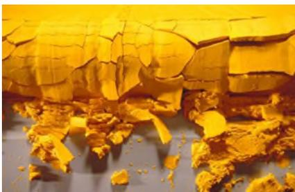
Pour que le dioxyde d'uranium obtenu dans le cadre de l'exploitation minière puisse être utilisé comme combustible dans un réacteur nucléaire, il doit être soumis à plusieurs étapes de traitement. Avant d'être enrichi, le minerai d'uranium est broyé en poudre puis passe par plusieurs étapes de traitement chimique. C'est ainsi qu'est produit le concentré d'uranium U3O8, appelé aussi «Yellow Cake».
