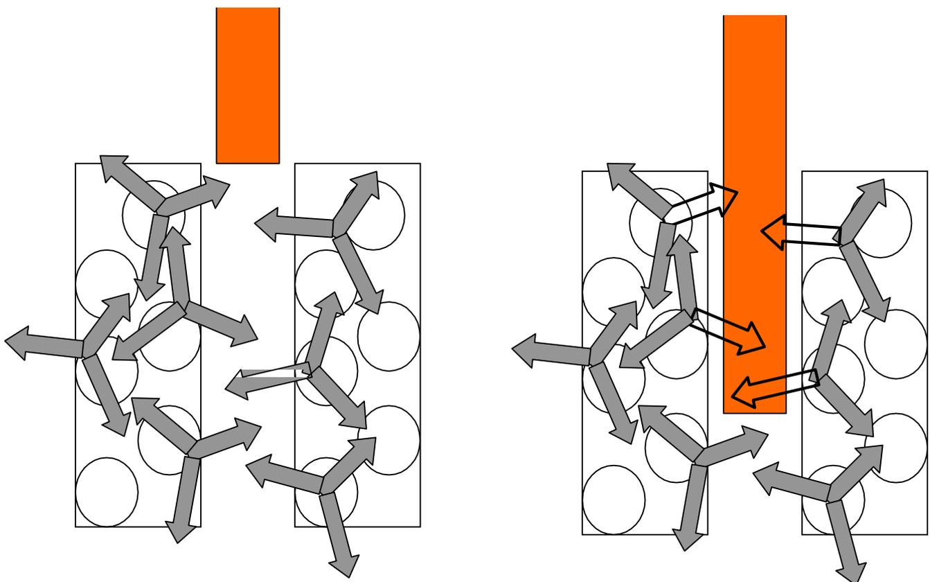
Le schéma de gauche représente les neutrons (flèche grise) qui apparaissent dans le cadre de la fission de l'uranium et engendrent à leur tour de nouvelles réactions de fission. Le schéma de droite représente une barre de commande (orange) poussée entre les assemblages combustibles et qui «avale» une partie des neutrons (flèche transparentes). Ces neutrons ne pourront alors pas donner lieu à une nouvelle réaction de fission et celle-ci ralentit progressivement.
