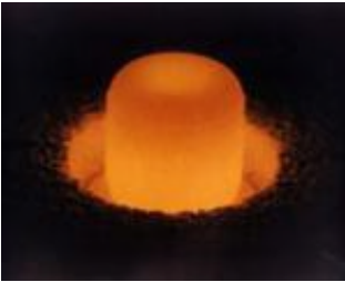
Une pastille de plutonium ( ^{238}\text{Pu} ) devient rouge en raison de sa propre désintégration.
